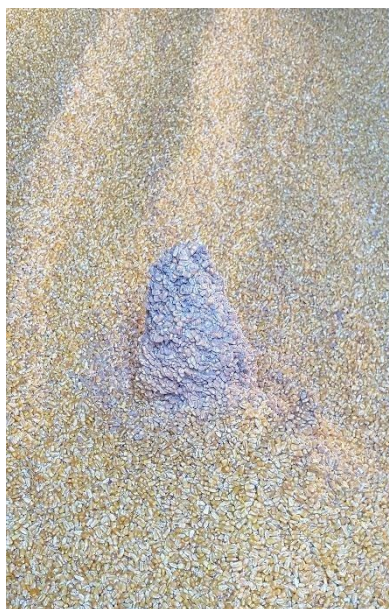
Figura 3.9. La evidencia de la pequeña cantidad de grano estropeado después de que se retiró parte del grano del silo después de aumentar las lecturas de CO 2 se observó en un silo durante un período de un mes, lo que indica que en el set de algunos deterioros y revelar la ubicación de la pequeña grieta en el panel del techo del silo que permitió que el agua goteara sobre la superficie del grano cada vez que llovía. Después de que la grieta se reparó adecuadamente, se eliminó el problema.
