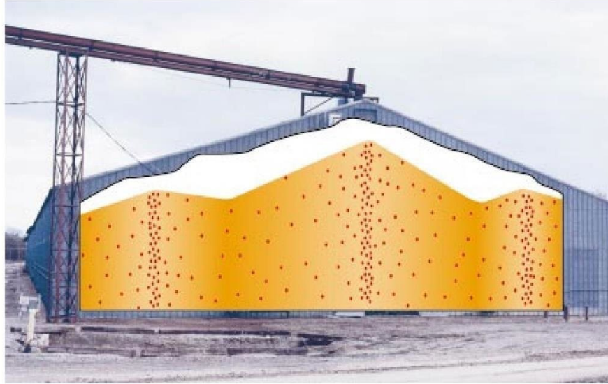
Figura 1.1. Ilustración de contornos formados debajo de los puntos de caída de tres transportadores aéreos paralelos que recorren la longitud del almacén lleno de maíz para su almacenamiento a largo plazo. (Fuente: USGC)
