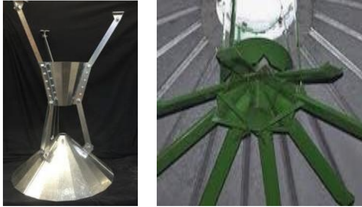
Figura 4.8. Ejemplo de un esparcidor de cono de gravedad (izquierda) y un esparcidor de múltiples rampas giratorio impulsado por gravedad (derecha) que dispersa el grano en el silo. Esto evita la acumulación de maíz roto y finos en el núcleo, y evita el pico de la masa de grano.
