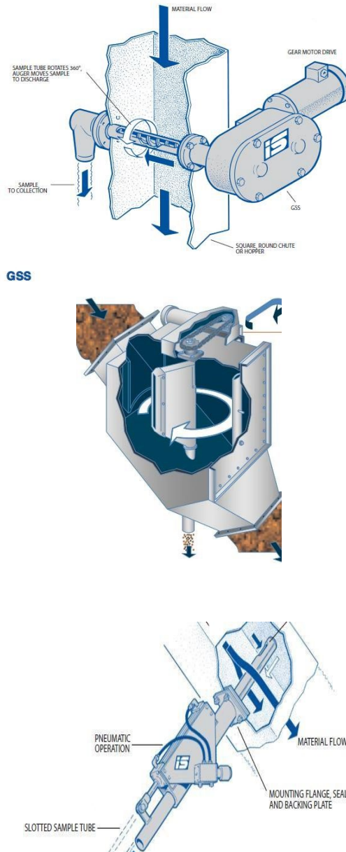
Figura 3.1. Muestreadores de flujo de grano en línea por gravedad utilizados para el muestreo representativo a medida que se descargan las bodegas y el grano se transfiere a un sistema de transporte.
