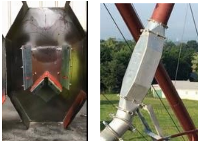
Figura 4.7. Ejemplo de un retardador de flujo instalado en un pico descendente por gravedad que reduce la velocidad del grano a medida que el flujo de grano se expande en el volumen del retardador.
