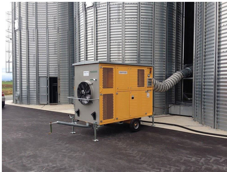
Figura 4.16. Sistema de aireación de grano refrigerado conectado al conducto de aireación de un individuo o conjunto de silos de acero. La unidad móvil se puede mover de un silo a otro, así como a lo largo de un almacén y conectarse a Conductos de aireación para enfriar y mantener la calidad del grano almacenado independientemente de las condiciones climáticas ambientales.
