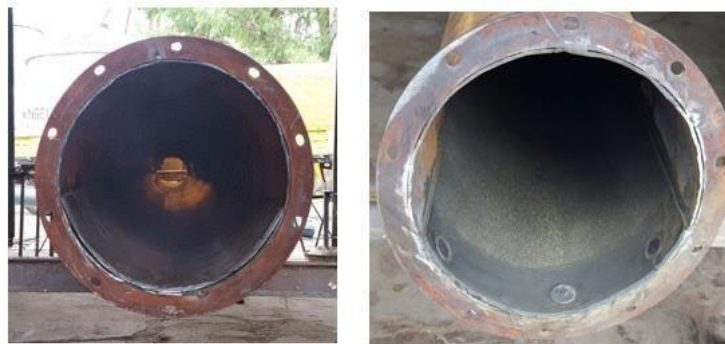
Figura 4.10. Ejemplos de material de revestimiento instalado dentro de bajantes para reducir la rotura adicional de maíz y el desgaste de las superficies metálicas internas.
