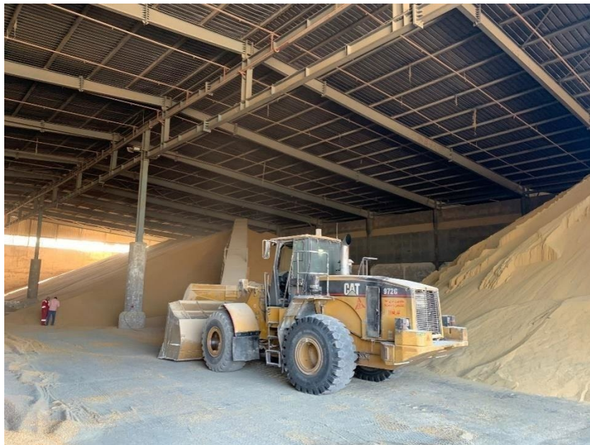
Figura 3.6. Cargador frontal que mueve el grano a un cargador de pila de grano.
